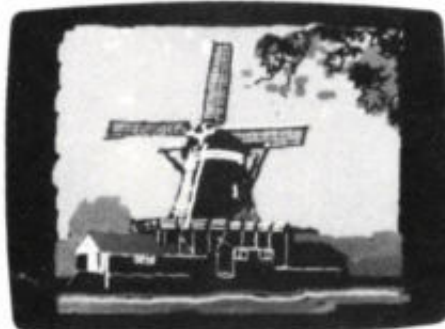
Afb. 2. Met de Europese CEPT-standaard en het „Vidibord“ grafisch invoertableau is een resolutie van 262 144 beeldelementen mogelijk.
